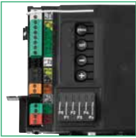
Interfejs programowania i wyjmowane bloki zacisków
